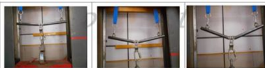
Deformação com carga de 104 kg Deformação com carga de 140 kg Deformação com carga de 265 kg
